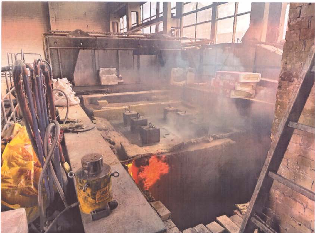
Рис. 8. Опытный образец мезонина на колоннах (образец № 2) с приложенной нагрузкой из расчета 200 \text{ кг/м}^2 , в процессе испытания
