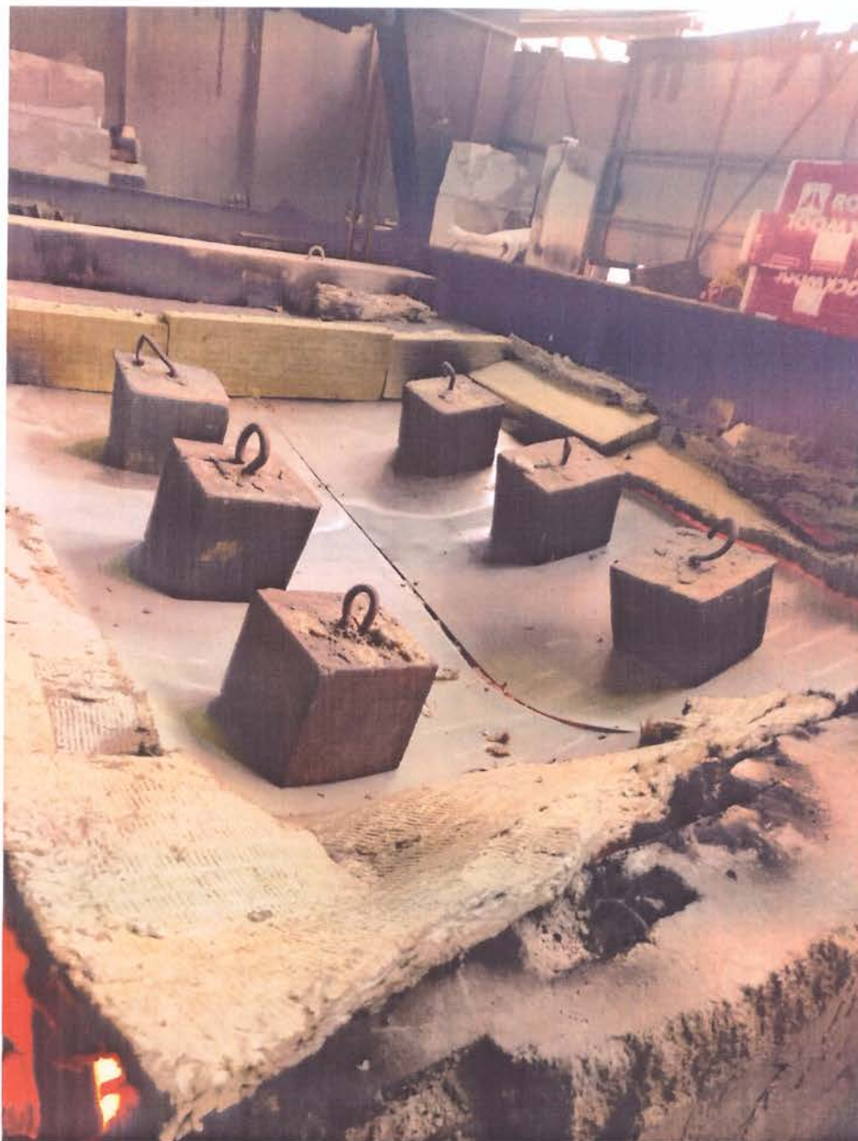
Рис. 9. 17-я мин – окончание испытания опытного образца мезонина на колоннах, вследствие достижения опытным образцом предельного состояния по несущей способности конструкции R, в результате превышения предельного прогиба и вертикальной деформации стоек образца
