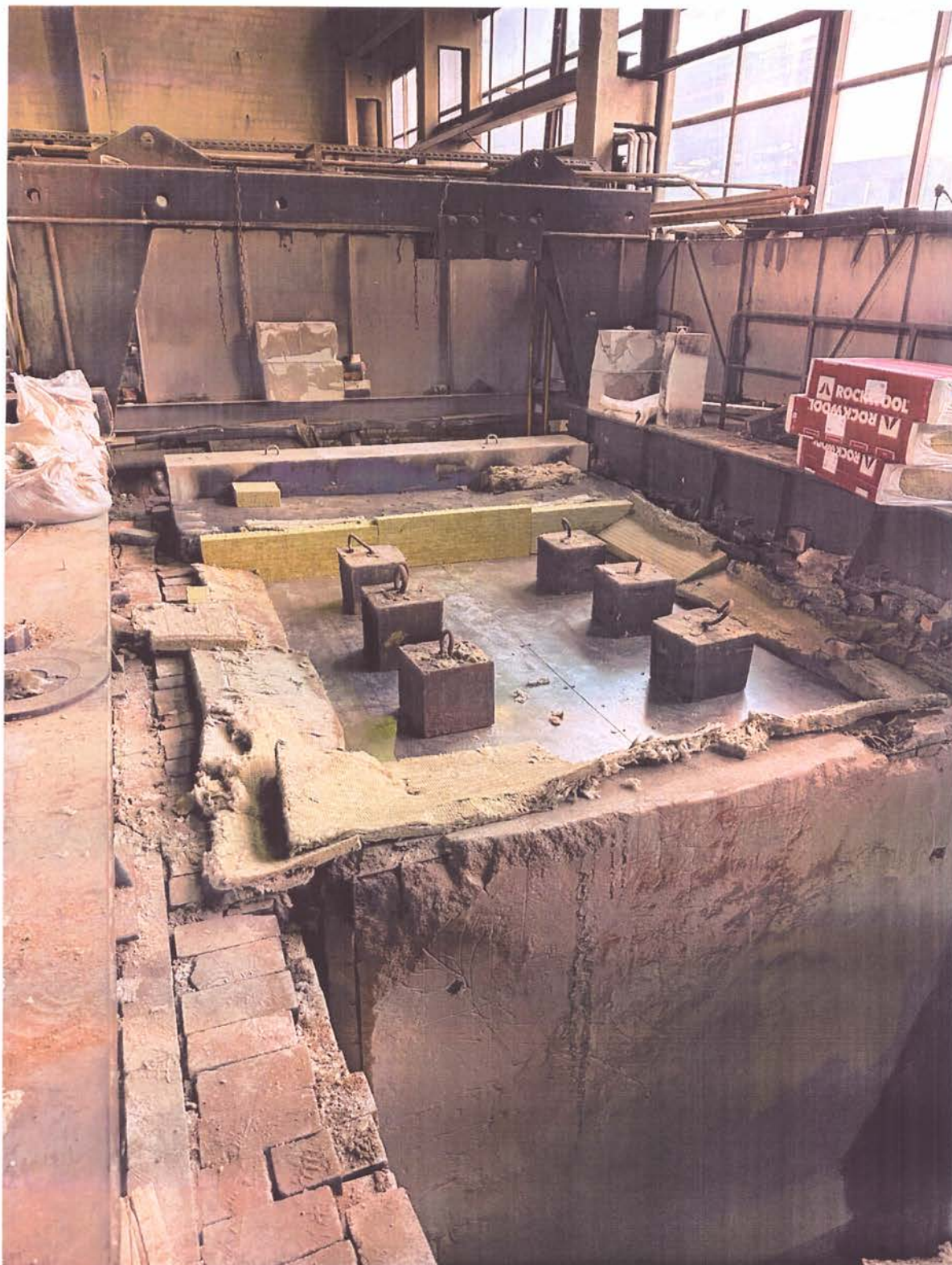
Рис. 5. Внешний вид опытного образца мезонина на колоннах (образец № 2) с приложенной нагрузкой из расчета 200 \text{ кг/м}^2 , согласно проектно-расчетной схеме (обязательное Приложение к настоящему Отчету)
