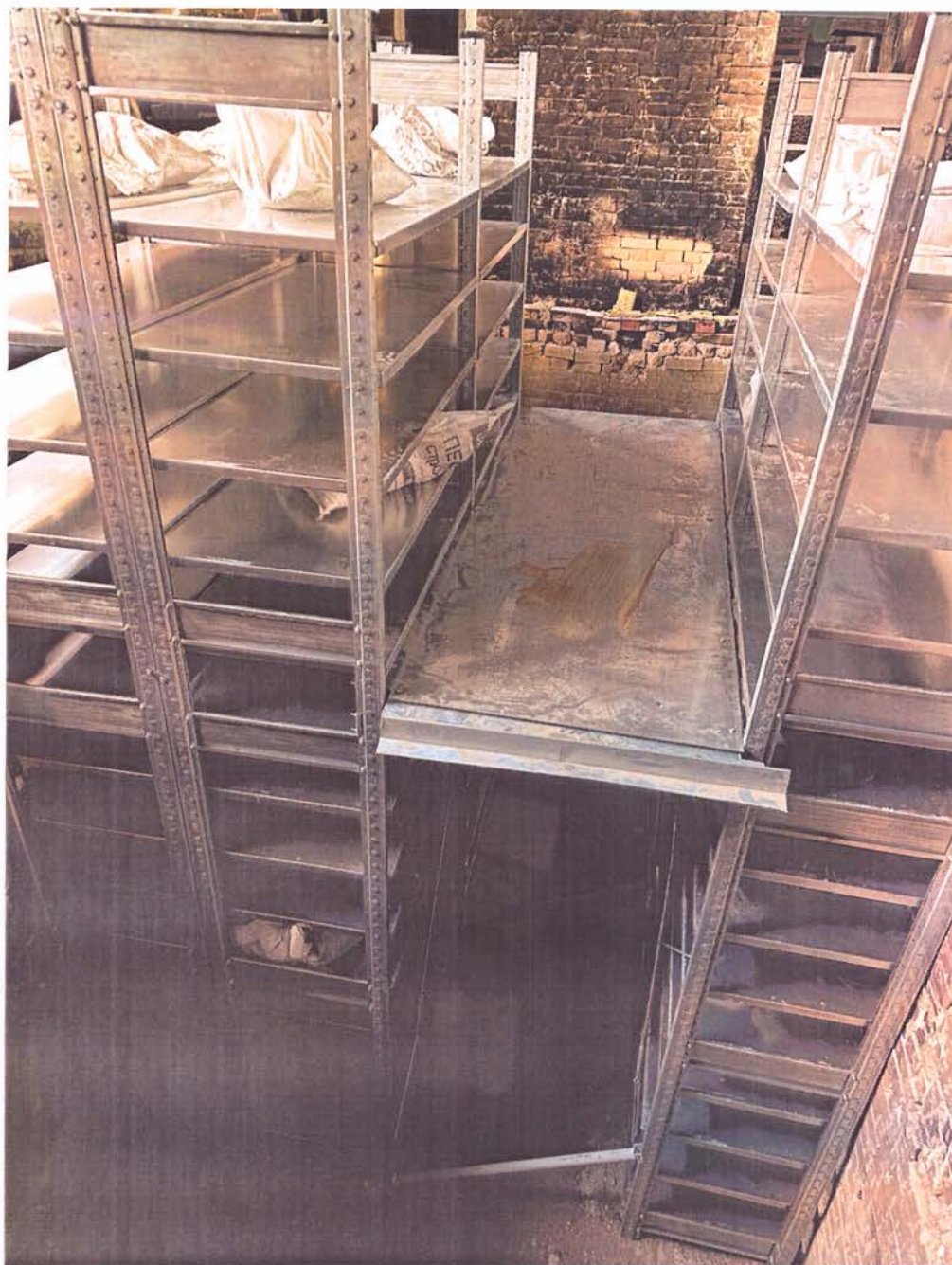
Рис. 2. Опытный образец № 1 фрагмента многоярусной конструкции мезонина, установленный в огневую камеру печи с приложенной нагрузкой, согласно проектно-расчетной схеме
