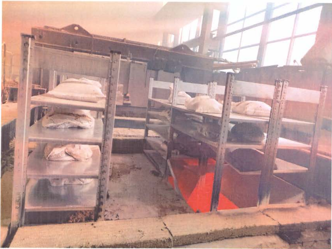
Рис. 7. 18-я мин – окончание испытания фрагмента многоярусной конструкции мезонина. Обрушения вертикальных и горизонтальных несущих элементов (стоек и балок) мезонина не зафиксировано
