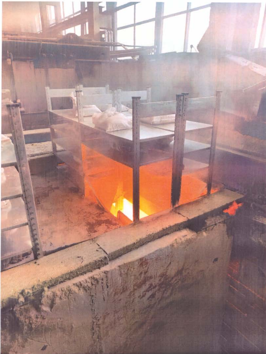
Рис. 6. Фрагмент многоярусной конструкции мезонина в процессе испытания (образец № 1). 10-я мин испытания – обрушение полок мезонина
